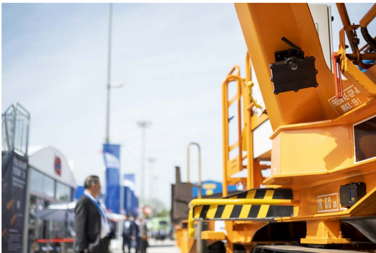
RMD:s järnvägskamera och PMU-sensor visades på transport logistic-mässan i München 9-12 maj 2023, på bilden monterad på ballastvagnen Fanps 2.0.
